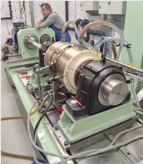
Konfiguracija za ispitivanje radijalnog polimernog klznog ležaja \phi 300 mm, \lambda=1 ; pogled s pogonske strane.
