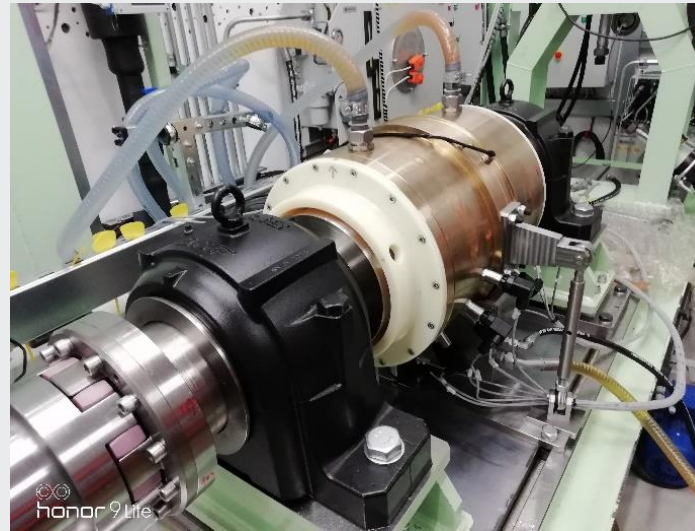
Konfiguracija za ispitivanje radijalnog polimernog klznog ležaja \phi 300 mm, \lambda=1 ; pogled s uređajima za opterećenje ispitnog ležaja.
